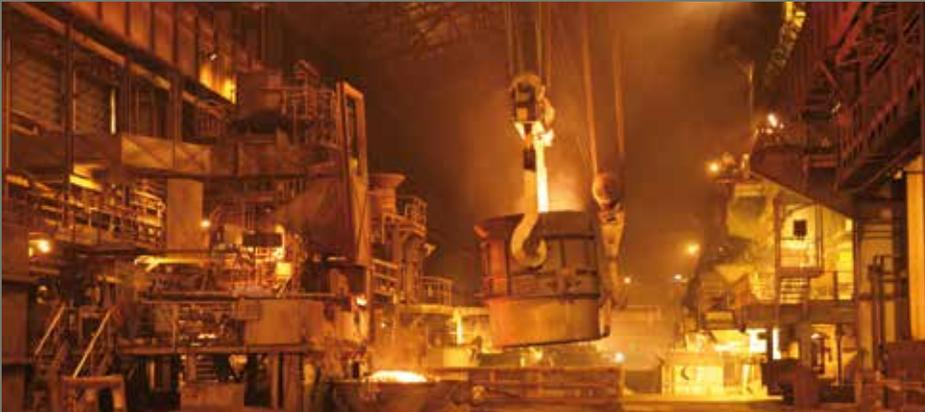
La poche de 37 tonnes contenant le métal en fusion est transportée vers la machine à lingoter permettant de solidifier le métal. L'opération est réalisée par un pontier installé 15 mètres au-dessus du sol.
