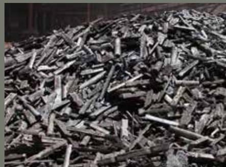
Les lingots encore chauds et fumants tombent dans la benne d'un camion qui les transporte jusqu'à l'atelier Bessemer où, après plusieurs nouvelles étapes, ils sont transformés en matte.
