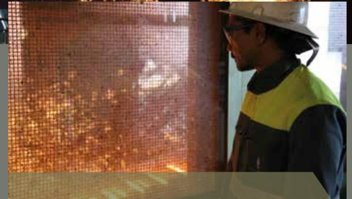
L'opérateur surveille le délicat transfert du métal bouillonnant sur la machine à lingoter, un tapis roulant composé d'augets en forme de lingots. Le métal sera refroidi grâce à un système de refroidissement par jet d'eau.
