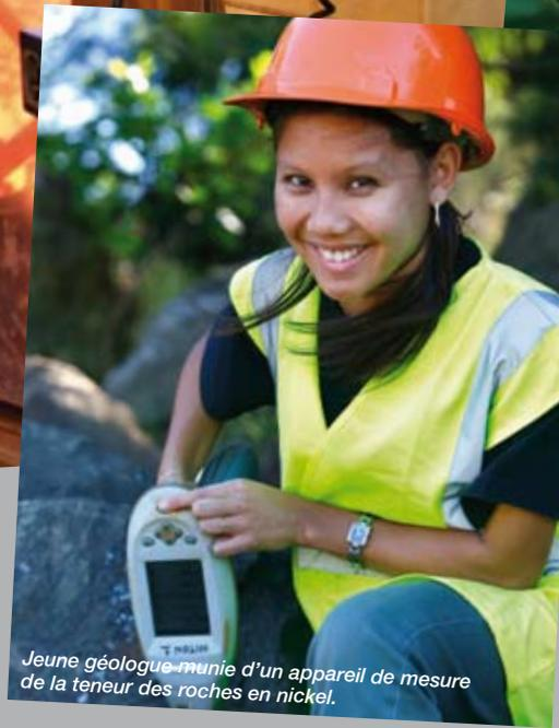
Jeune géologue munie d'un appareil de mesure de la teneur des roches en nickel.
